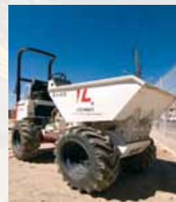
BASCULEURS À PNEUS MINI DUMPER 4x4 / CAPACITÉ 600 L
